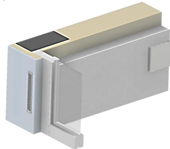
Einbau bei geringer Wandscheibe - Außenansicht
